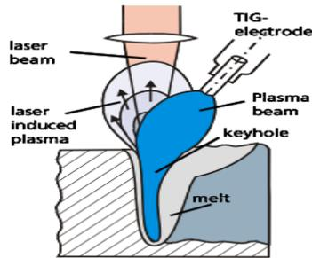
Fig. 1. Laser-GTA Hybrid Welding System.
