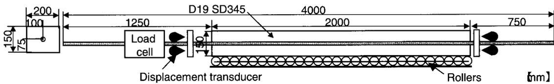
Fig. 9. Test setup
