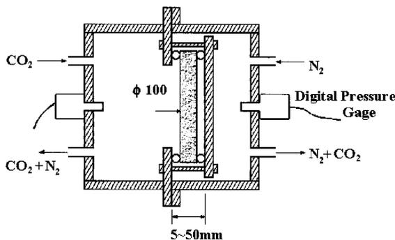
Fig. 2. Gas diffusion cell
